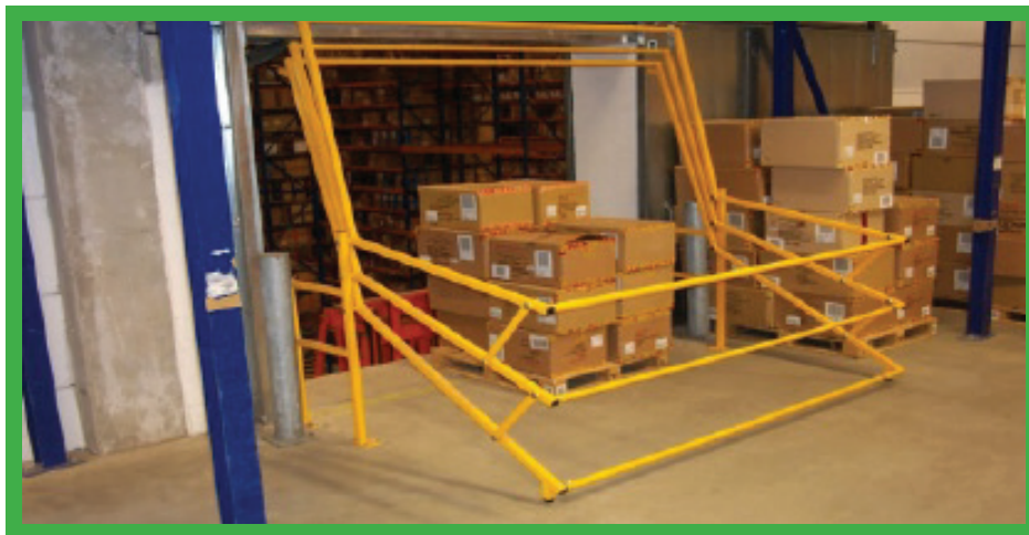
Forgó keretrendszer, amely védelmet biztosít a leesések ellen.
