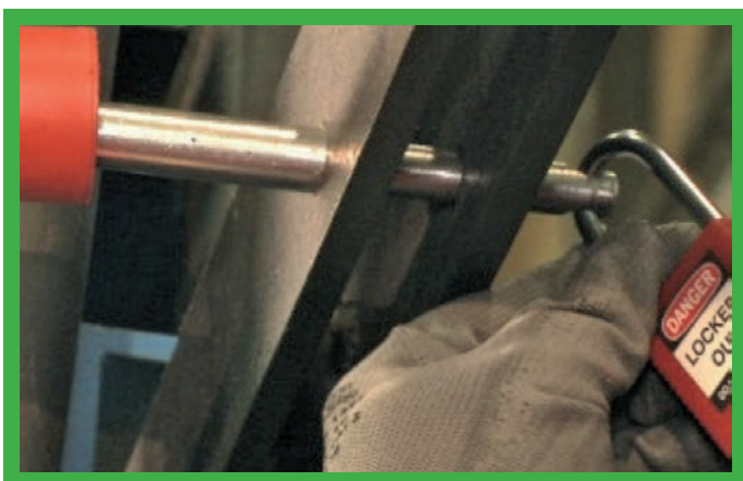
Mechanikus leválasztás: védelem egy tolóajtónál (mechanikus + lakat).
