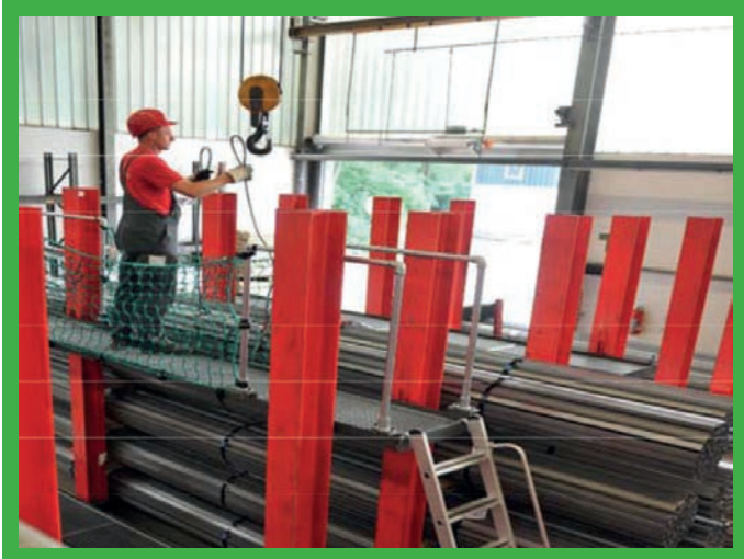
Biztonságos hozzáférés az emelőkampók felszereléséhez.
