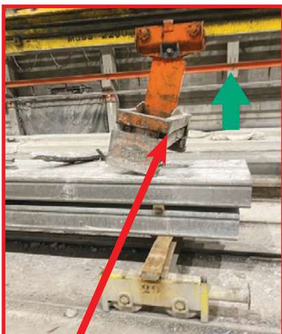
Keď bola doska spustená do polohy - obsluha uvoľnila svorky a zdvihla ich vyššie nahor, aby ich posunula k ďalšej úlohe.
