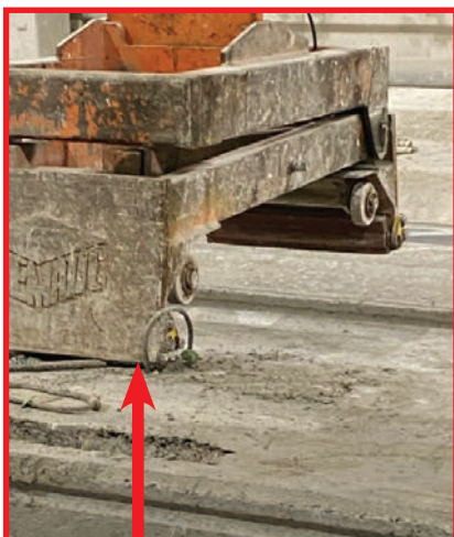
Keď sa však svorky posunuli nahor, spojili sa so zdvíhacím okom. Tento ťah na úchyt spôsobil, že sa doska posunula a skĺzla z hromady dosiek (pozri ďalšiu fotografiu) – operátor predpokladal, že svorky sú úplne uvoľnené.
