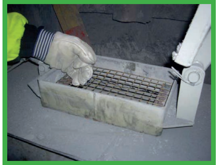
Inšpekčný poklop (so zaistenou mriežkou) na závitnicovom dopravníku.
